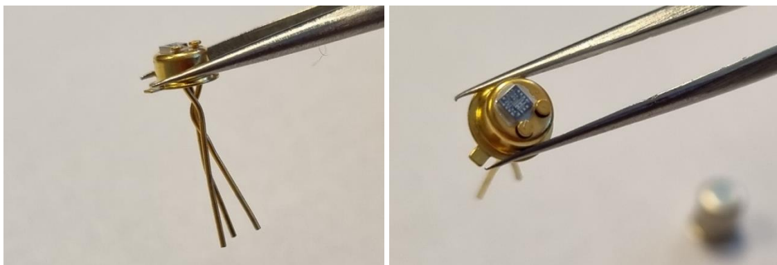
1.attēls. Izgatavotā mikrotriodes struktūra ar noņemto vāciņu.
